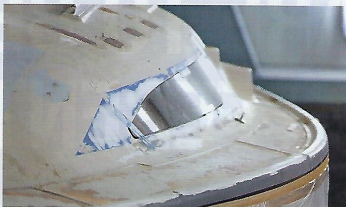
Links das Deck im Urzustand, rechts nach dem Spachteln, Schleifen und Grundieren
