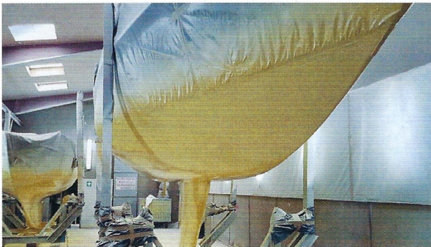
400 Mikrometer aufgespritztes Epoxidharz vervollständigen als effektive Dampfsperre den „Osmose-Schutzmantel“.
