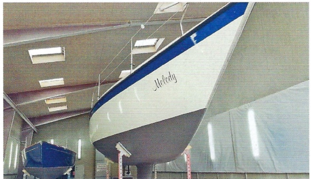
Nach der grundlegenden Sanierung ist das Unterwasserschiff wieder strukturell gesund und deutlich besser gegen Osmose geschützt als beim Stapellauf.
