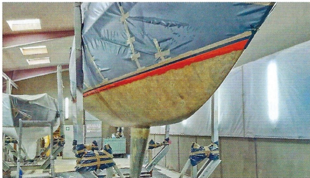
Die Oberfläche eines von Osmose befallenen Unterwasserschiffes nach dem kompletten Strahlen, die tiefen Nester wurden ausgebohrt.
