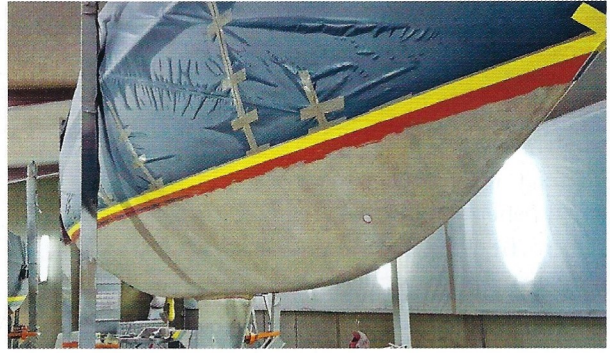
Durch Strahlen wurde das Unterwasserschiff von allen Altanstrichen und dem Gelcoat befreit, bis das Laminat komplett freiliegt.
