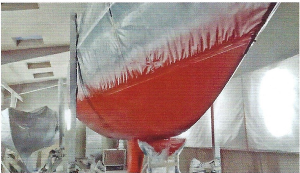
Nun wird eine Indikatorschicht gespritzt, um den Antifoulingabtrag kontrollieren zu können. So lässt sich der Zeitpunkt für einen Neuauftrag gut bestimmen.
