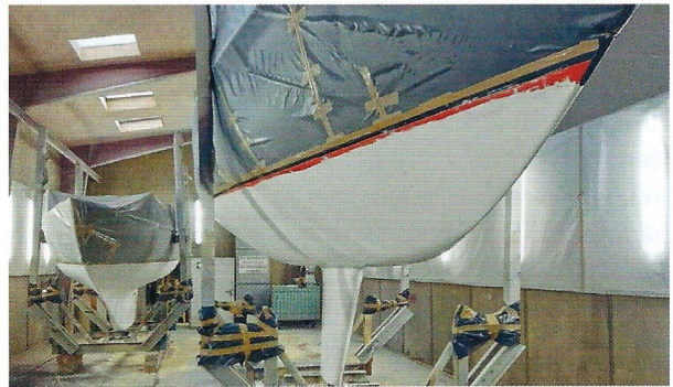
Mit Vinylesterharz wird neues Glasfaserlaminat aufgebracht, um die strukturelle Festigkeit des Rumpfes wiederherzustellen.
