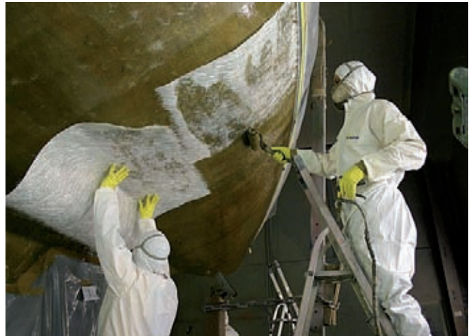
Auflaminieren des Bearbeitungsbereiches mit Glasmatten in hydrolysefestem Vinylesterharz dient als Feuchtigkeitssperre und zur Verstärkung des Rumpfes. Copyright Peter Wrede
