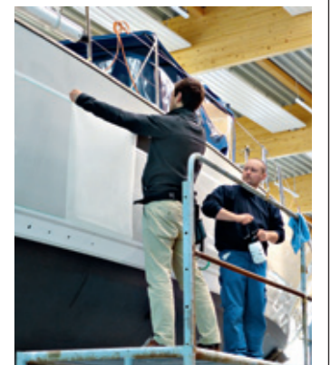
Fenderprotect-Folie schützt den Rumpf vor dem Fender-Abrieb
