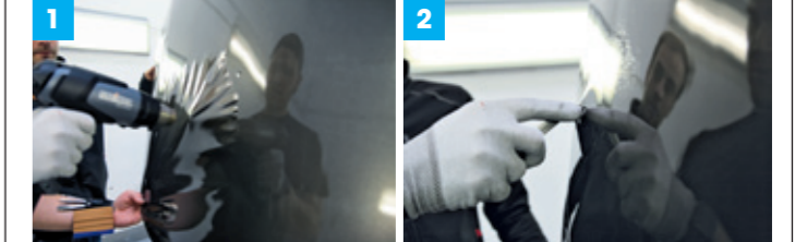
Rund um den Borddurchlass wird die Folie erwärmt (1) und mit dem Rakel in Richtung Durchlass glattgestrichen. Mit dem Cutter wird die Folie eingeschnitten (2).
