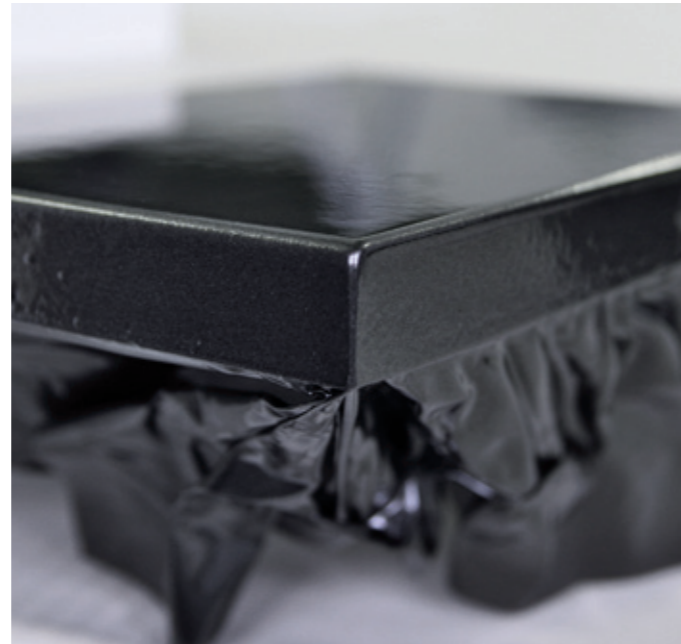
Selbst komplizierte Konturen lassen sich ohne Schnitte folieren
