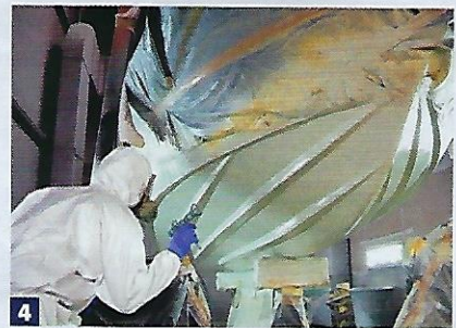
4 Signalwirkung Schimmert irgendwann die grüne Indikatorschicht wieder durch, kann partiell nachgebessert werden
