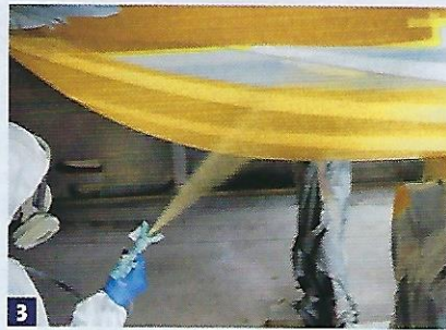
3 Bund fürs Leben Der aufgesprayte Antifoulingprimer sorgt für die optimale Verbindung zum Epoxid-Untergrund
