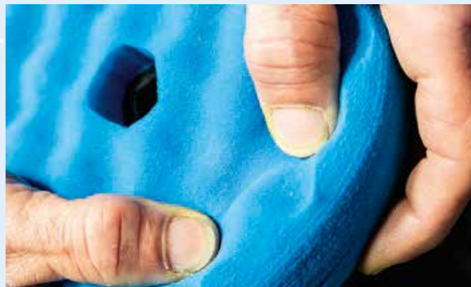
Waffelpads dienen zum Auftragen von Versiegelungen, glatte zum Polieren
