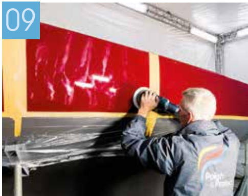
07 Der Farbstich im Pad zeigt den abrasiven Prozess: rotes Gelcoat wird abgetragen.
