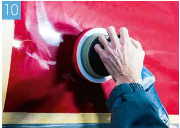
10 Mit einem Waffelpad wird die Versiegelung aufgetupft.
