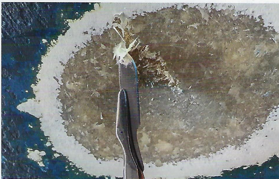
Die Blase wurde geöffnet und das Laminat tritt zu Tage: Diagnose Osmose.
